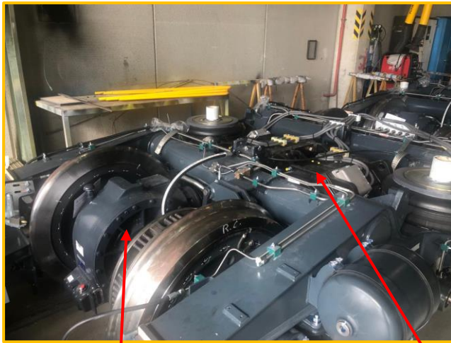
Acoplamiento con el reductor
