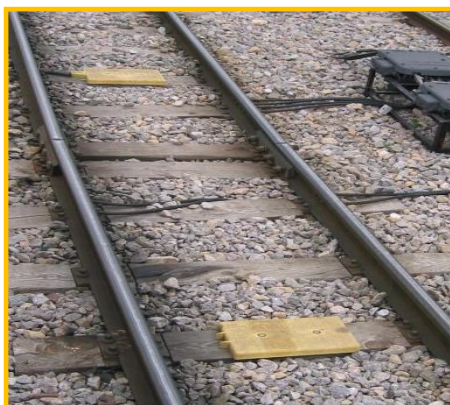
Balizas del FAP y del ATP ZSI 127
