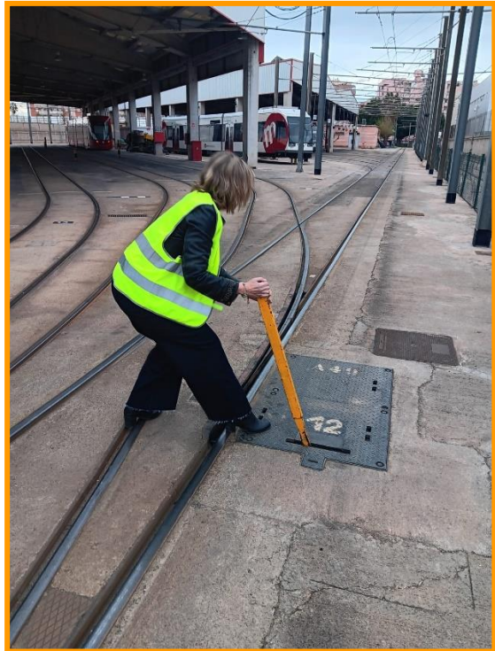
Accionamiento manual en caso de fallo
